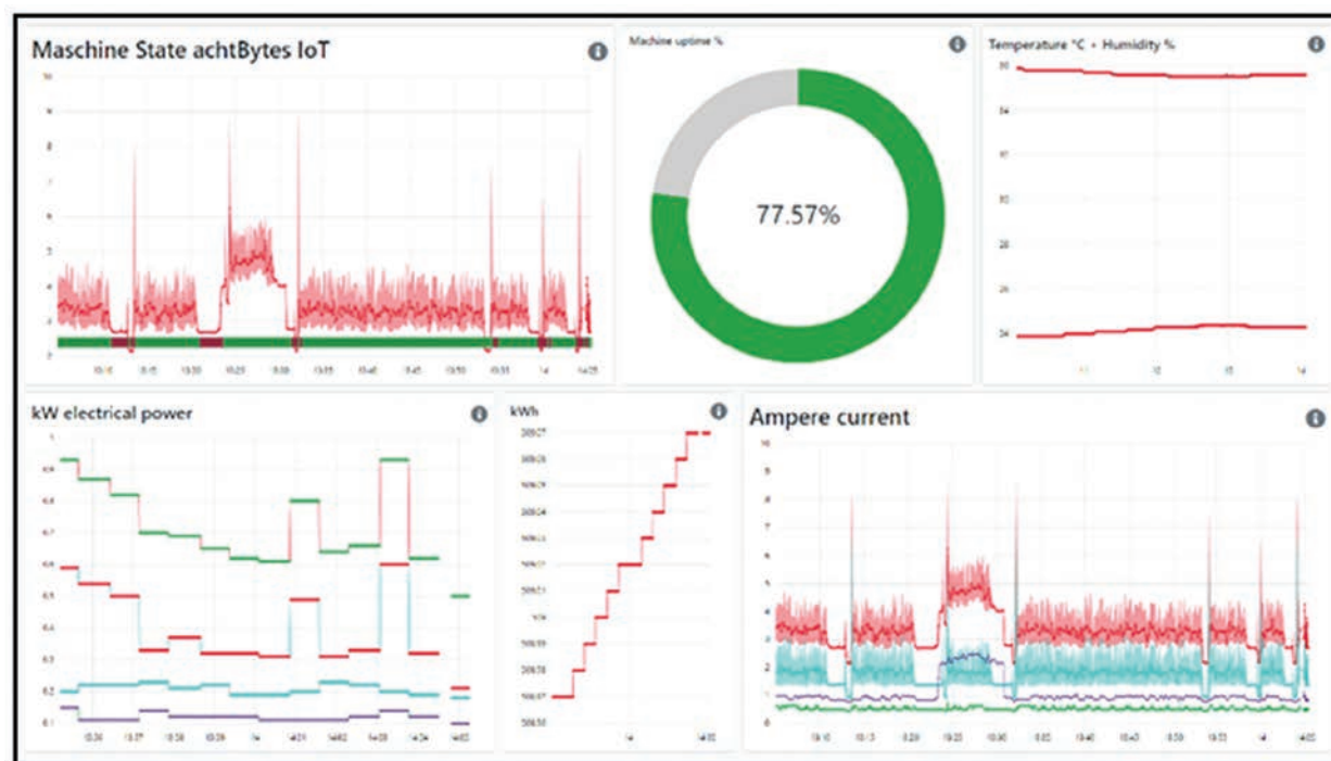
Monitorizarea continuă a parametrilor folosind platforma IIOT de la achtBytes ( www.achtbytes.com )
